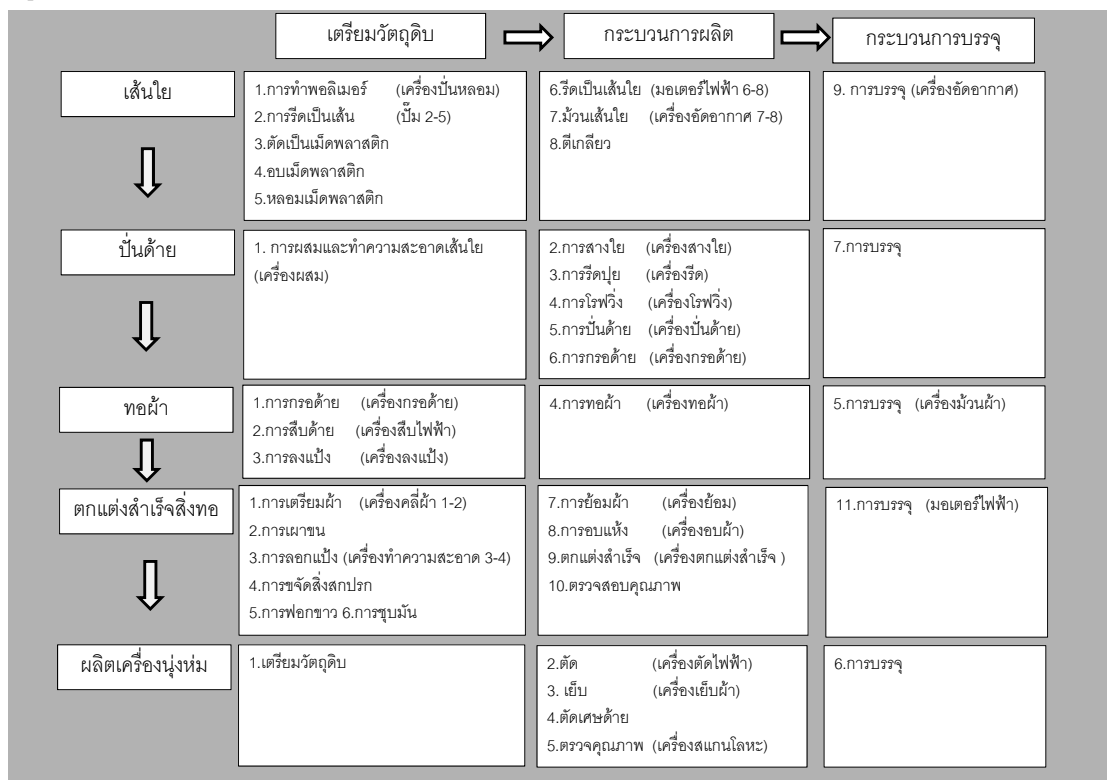
รูปที่ 1 แผนผังกระบวนการผลิตและเครื่องจักรหลักที่ใช้พลังงานของอุตสาหกรรมสิ่งทอประเทศไทย
