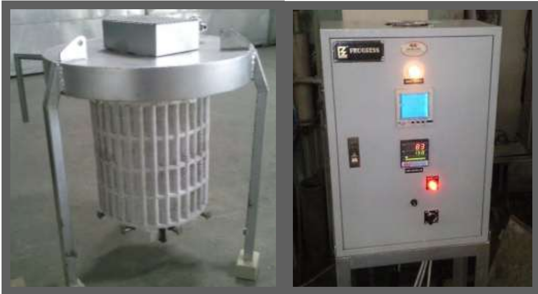
รูปที่ 4 ฮีตเตอร์ไฟฟ้าที่ใช้ในการทดลอง (ซ้ายมือ) และ ตู้ควบคุม (ขวามือ)
