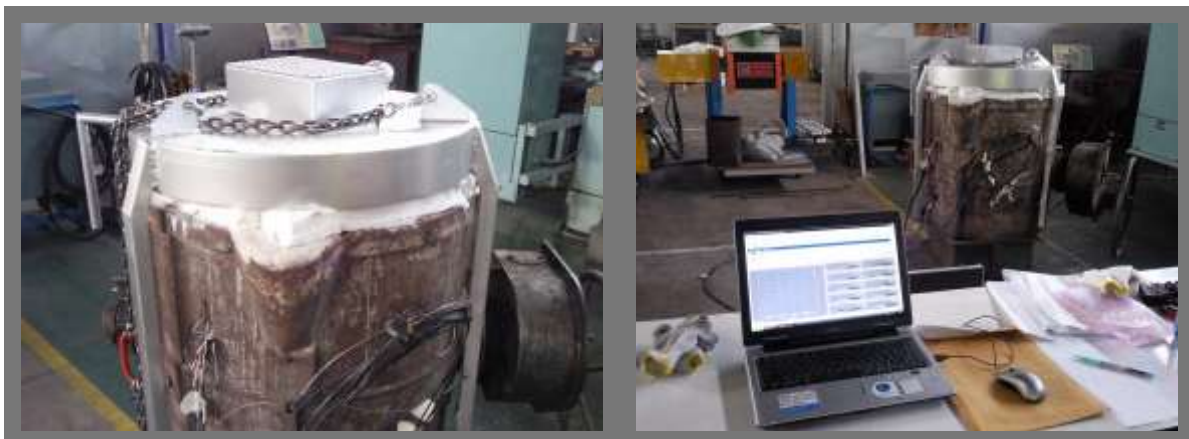
รูปที่ 7 การติดตั้งฮีตเตอร์ไฟฟ้าขณะใช้งาน (ซ้ายมือ) และการตรวจวัดและบันทึกข้อมูลในขณะที่ทำการทดลอง (ขวามือ)
