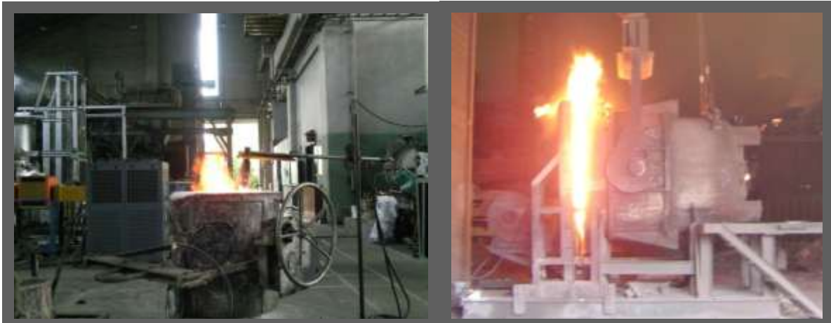
รูปที่ 2 ตัวอย่างการอุ่นเข้รับน้ำเหล็กขนาดความจุ 1 ตันน้ำเหล็ก (ซ้ายมือ) และ 25 ตันน้ำเหล็ก (ขวามือ)
