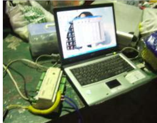
รูปที่ 7 การบันทึกอุณหภูมิต่างๆด้วย data logger
