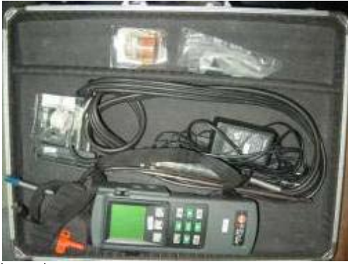
รูปที่ 5 เครื่องมือวิเคราะห์ก๊าซเสียจากเตา reheating furnace และ recuperator
