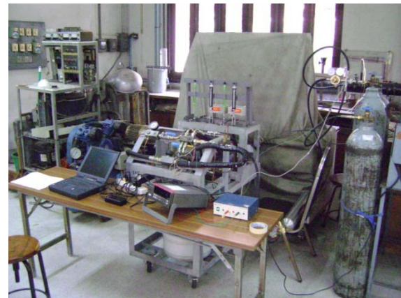
รูปที่ 11 อุปกรณ์ที่ใช้วัดและบันทึกค่าอุณหภูมิ, ความดัน
