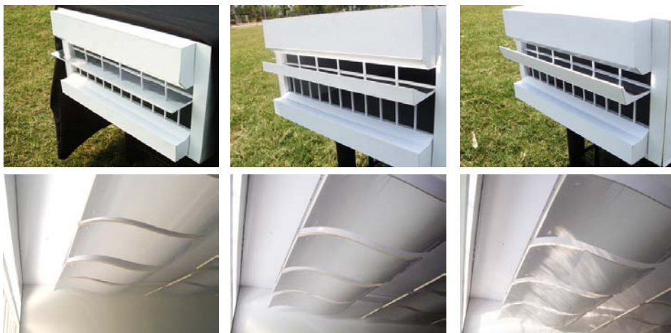
ภาพที่ 8 แสดงการเปรียบเทียบการใช้ แผงสะท้อนแสงเหนือระนาบทำงานโค้ง วัสดุกระจังแสงที่ระดับ 2.75 ม.ร่วมกับหิ้งสะท้อนแสงลักษณะต่างๆ
