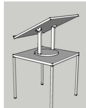
รูปที่ 4 แสดงลักษณะของ Heliodon
