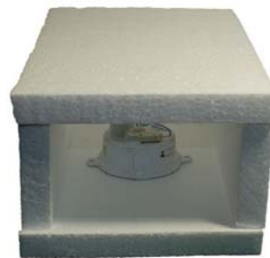
ภาพที่ 15 การใช้โฟม 1 นิ้ว ปิดทั้ง 4 ด้านเพื่อป้องกัน อิทธิพลจากรังสีอาทิตย์ที่ส่งผลต่ออุณหภูมิอากาศ ของ
