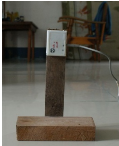
ภาพที่ 16 ลักษณะการติดตั้ง data logger ยี่ห้อ HOBO รุ่น multi-channel reusable data logger HO8-007-02 สูงจากพื้นเรือนประมาณ 30 เซนติเมตร
