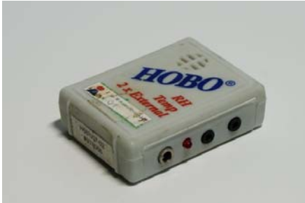
ภาพที่ 13 อุปกรณ์ data logger สำหรับเก็บข้อมูล อุณหภูมิอากาศและความชื้นสัมพัทธ์ ภายในเรือน ยี่ห้อ HOBO รุ่น multi-channel reusable data logger HO8-007-02
