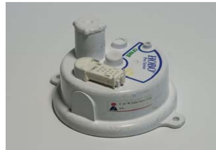
ภาพที่ 12 อุปกรณ์ data logger สำหรับเก็บข้อมูล อุณหภูมิอากาศและความชื้นสัมพัทธ์ ภายนอกเรือน ยี่ห้อ HOBO รุ่น pro data logger HO8-032-08
