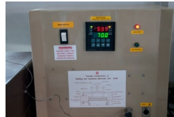
ภาพที่ 21 เครื่องมือสำหรับทดสอบคุณสมบัติการต้านทานความร้อน (k) ของวัสดุ
