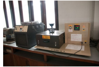
ภาพที่ 20 เครื่องมือสำหรับทดสอบคุณสมบัติการต้านทานความร้อน (k) ของวัสดุ
