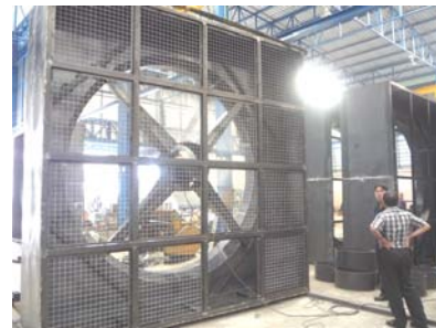
รูปที่ 3 พัดลม Propeller Type ที่ทำการติดตั้ง
