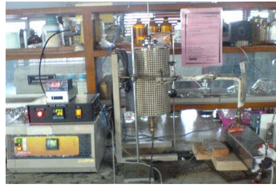
รูปที่ 3.2 ชุดอุปกรณ์เครื่องมือคาร์บอนไนเซชันตะกอนเปียก
