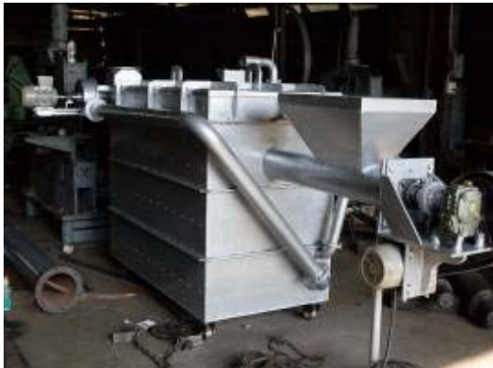
รูปที่ 3.1 เครื่องอบไล่ความชื้นตะกอนเปียก Screwdry กำลังการผลิต 100 กก./ชม.
